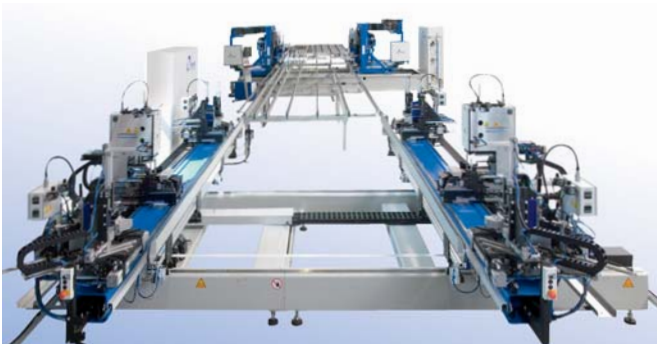
Lorillard-Rahmenlinie mit 6-Kopf-Schweißmaschine und anschließendem horizontalem 2-Kopf-Putzer
