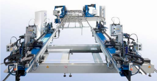
Lorillard-Rahmenlinie mit 6-Kopf-Schweißmaschine und anschließendem horizontalem 2-Kopf-Putzer
