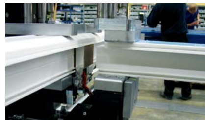
Millimetergenaue Positionierung des Kämpfers
